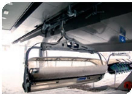
*Le garde-corps s'abaisse automatiquement avant la sortie de gare.*
